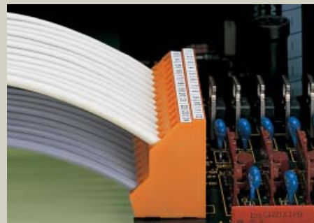
Экономия места при использовании двухуровневых клеммных колодок
